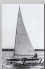
Le premier hydrofoïl de Baker (ci-dessus). En septembre 1950, il atteint 14 nœuds. Des fentes sur les foils lui permettront d'atteindre 20 nœuds plus tard. Ci-contre, Gordon Baker et Neil Lien au volant de Monitor , pour sa première sortie, le 24 août 1955.
