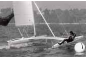
Kotaha à la Semaine de Weymouth 1972. Muni d'une voile de 30 mètres carrés, ce prao était doté de trois foils en aluminium.
