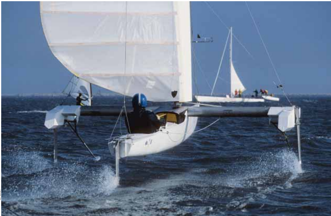
Kotaha à la Semaine de Weymouth 1972. Muni d'une voile de 30 mètres carrés, ce prao était doté de trois foils en aluminium.
